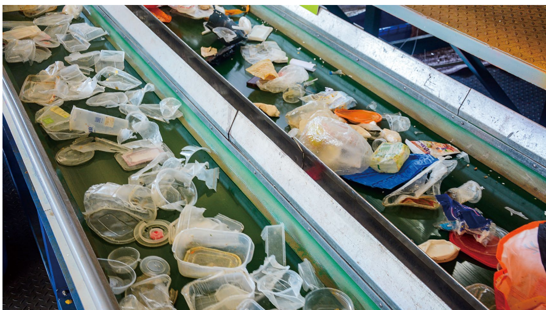
图9. 厦门陆海环保自研分拣线支持将餐盒按颜色自动化分选
